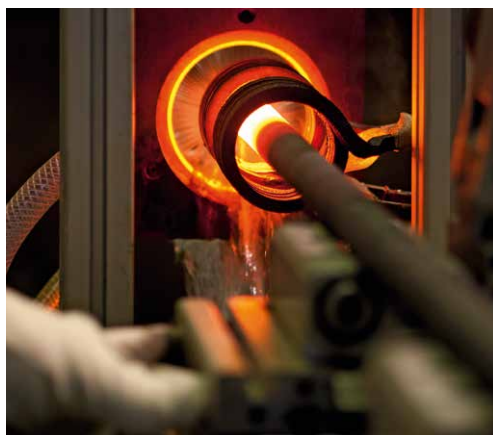
Induktives Härten der Meißel Inductive tempering
