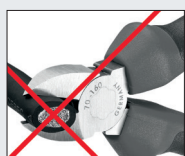
Bild 1: Kabelschnitt mit Seitenschneider: hoher Kraftaufwand, unsauberer Schnitt, starkes Verformen und Quetschen des Kabels
